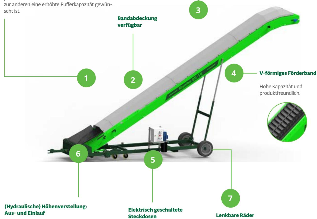
**(Hydraulische) Höhenverstellung: Aus- und Einlauf**
