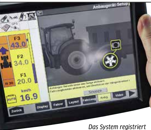
Das System registriert die Eingreifzeiten ins Bremssystem. Droht eine Überhitzung der Anhängerbremsen, erhält der Fahrer auf dem Schlepperterminal einen Hinweis. Fotos: Brüse
