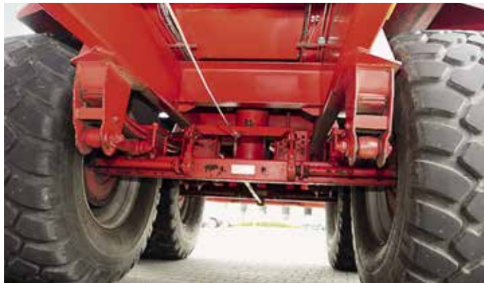
Die Bremsen des Anhängers werden mit dem neuen Bremssystem auch angesteuert, wenn der Fahrer nicht auf die Schlepperbremse tritt, sondern beispielsweise die Geschwindigkeit über den Fahrhebel verringert.
