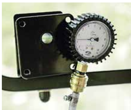
Anhand des Manometers konnten wir während der Fahrt die Druckänderungen in der Steuerleitung beobachten.
